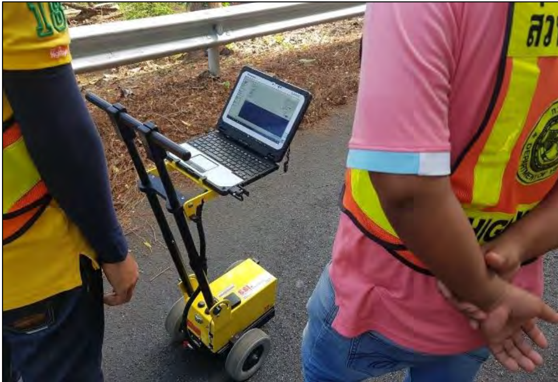
รูปที่ 2-185 เครื่องมือวัดความเรียบของผิวทางชนิดรถเข็น (SSI Walking Profiler)
